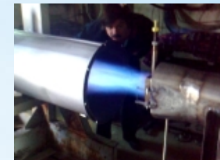
Burning test rig.
