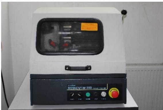
Figura 4. Echipamentele de pregatire metalografica: a) Masina de debitat Metacut-M250 Manual Cutter; b) Masina de slefuit Forcipol 2V
