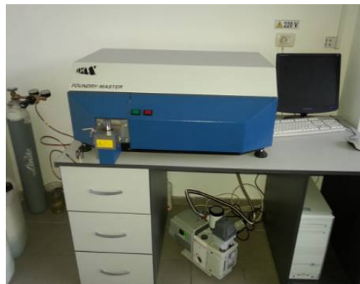
Figura 5. a) Instrument pentru masurarea grosimii acoperirii; b) Spectrometru cu emisie optica
