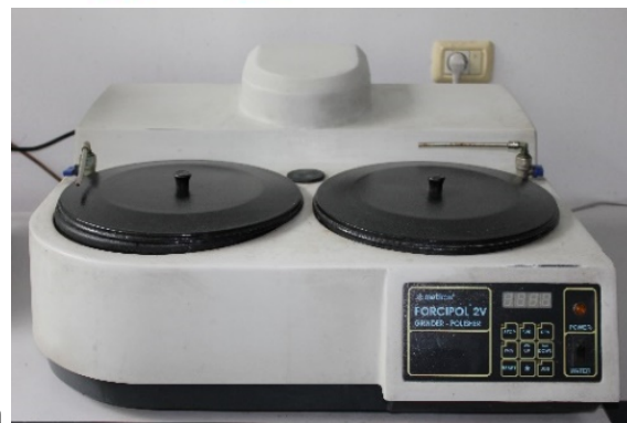
Figura 4. Echipamentele de pregatire metalografica: a) Masina de debitat Metacut-M250 Manual Cutter; b) Masina de slefuit Forcipol 2V
