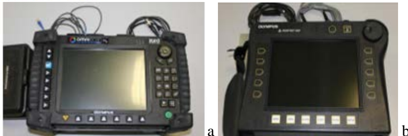
Figura 6. a) Detector cu ultrasunete; b) Detector cu curenti turbionari
