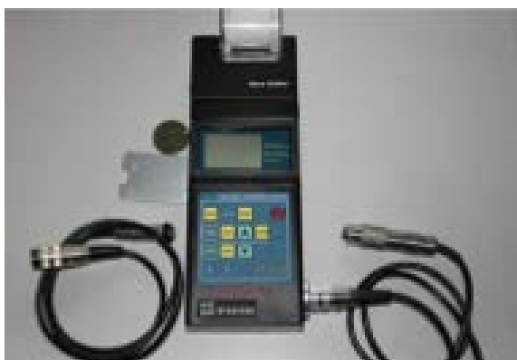
Figura 5. a) Instrument pentru masurarea grosimii acoperirii; b) Spectrometru cu emisie optica
