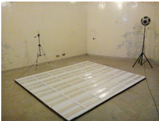
Figura 23. Amplasarea epruvetei de incercare in camera reverberanta
